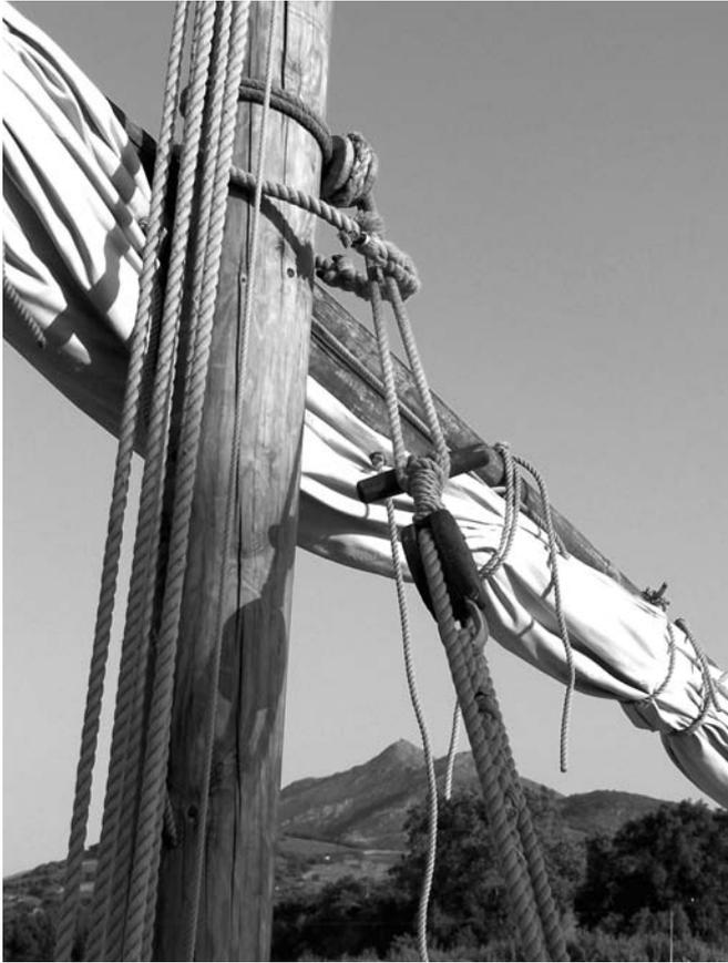
Détail du gréement latin. Mât contre lequel repose l'antenne qui soutient la voile latine.
